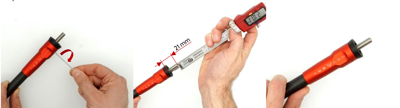
2.9 Ziehe die 2 mm Klemmschraube mit leichtem Drehmoment an.
